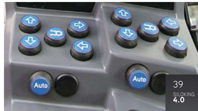
Разгрузочные транспортеры управляются просто нажатием кнопки в кабине водителя.
